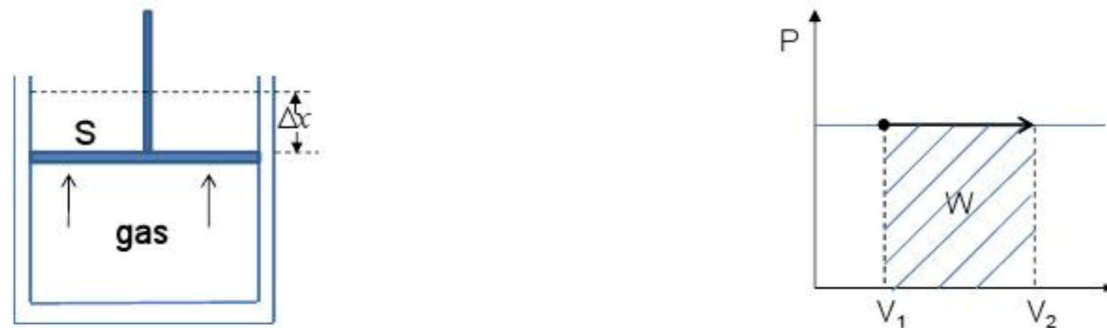
Figura 3.4. Trabajo de expansión de un gas a presión constante y diagrama P-V.
