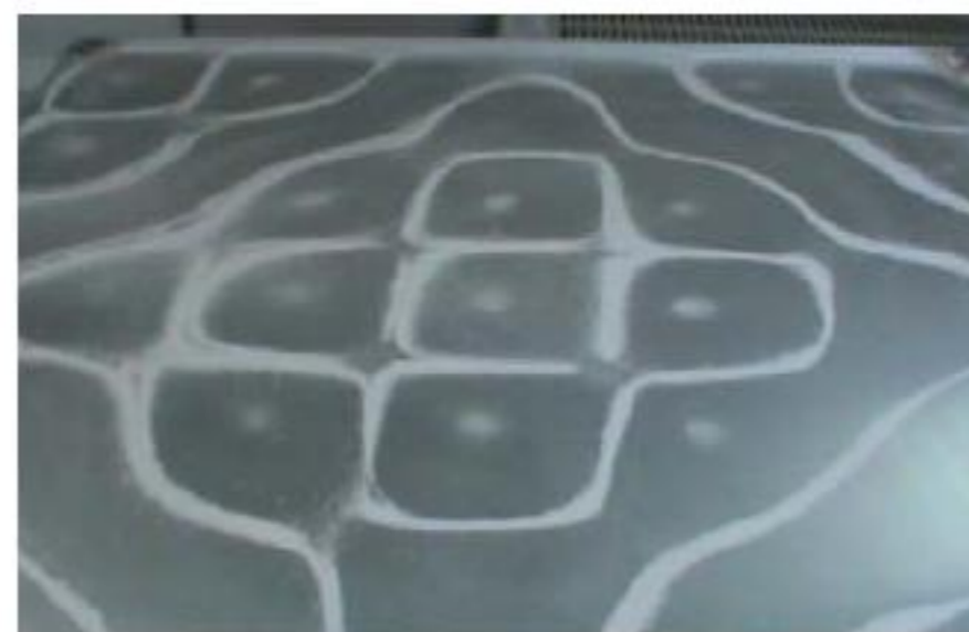
Figura 6.24. Modos de vibración en una placa metálica cuadrada.
